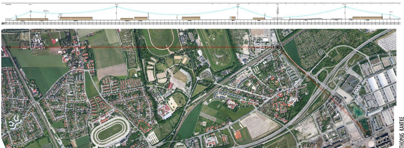
Luftbild mit Trassenführung und Längsschnitt
